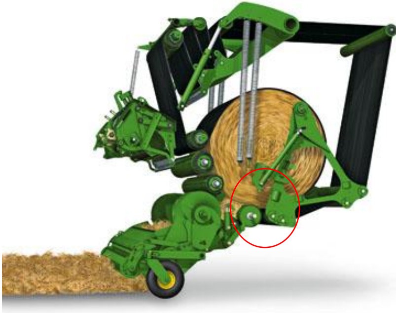
Obrázek 22: Mechanismus lisu na balíky John Deere, řada 900. Zdroj: www.robert-aebi-landtechnik.ch/siteindex.cfm?id_art=103173
