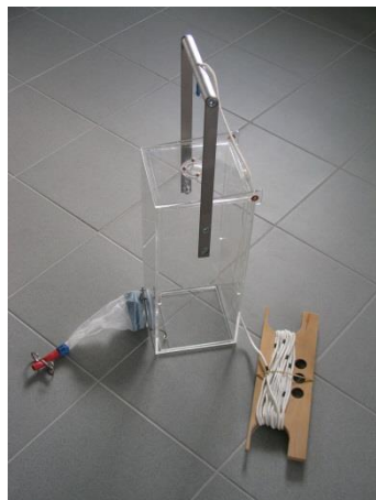
Foto 8. Odběrové zařízení typu Schindler na kvantitativní vzorkování zooplanktonu
