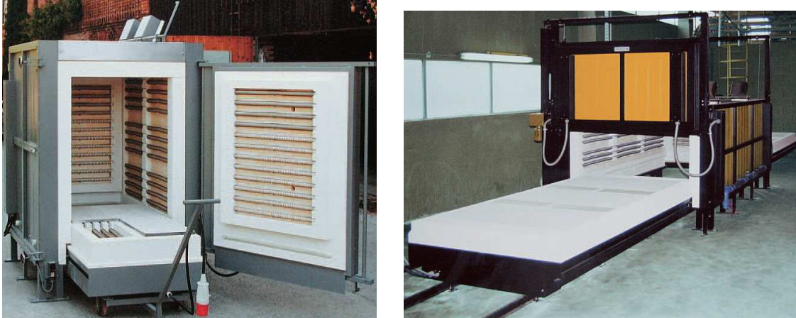
Obrázek 6: Vozokomorové pece typu „HWE“
