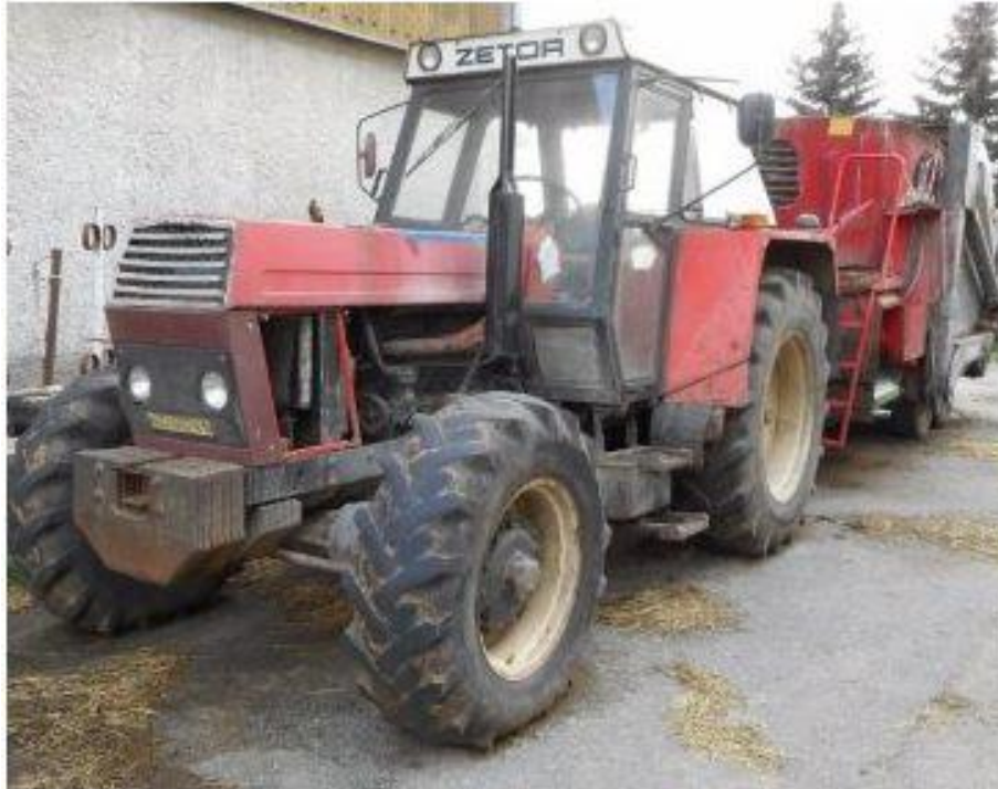
Obrázek č. 12 – Krmná souprava (Zetor 8145 turbo + BvL V-Mix plus), autor: Dvořák David
