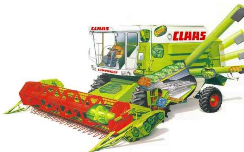
Obrázek 13 – CLAAS Commander s rotačními separátory
