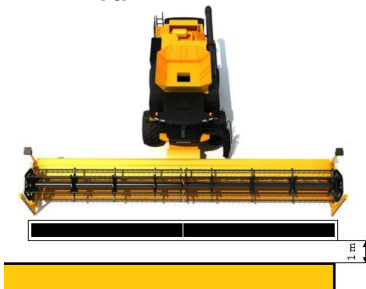
Obrázek 19 - Umístění odběrné plachty
