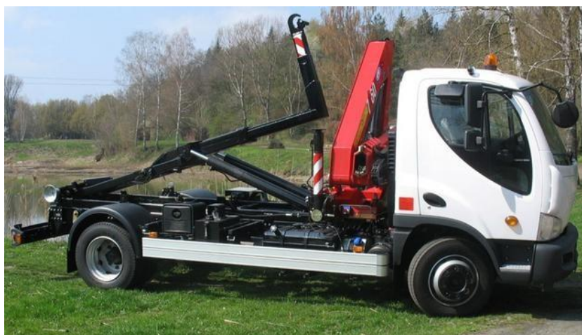
Obrázek 7 - Vozidlo s nástavbou nosič kontejnerů
