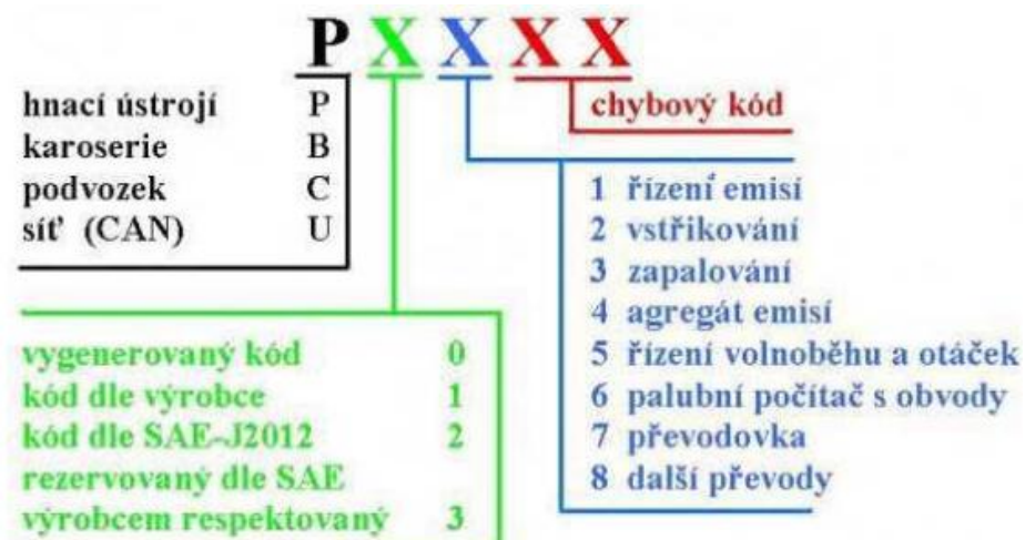
Obrázek č. 15 - Složení chybového kódu OBD, zdroj: ( http://blog.autodiagnostik.cz/autodiagnostika-eobd ,
