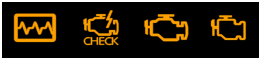
Obrázek č. 14 - Druhy kontrolky MIL, zdroj: http://blog.autodiagnostik.cz/autodiagnostika-eobd , („staženo dne 16. 1. 2016“)
