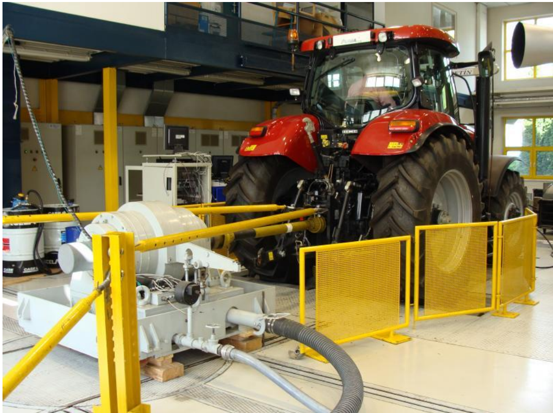
Obrázek č. 8 – Měření výkonu dynamometrem přes vývodou hřidel, zdroj: http://www.agrics.cz/obrazky-soubory/dsc00752-b66383.jpg , („staženo dne 13. 4. 2016“)
