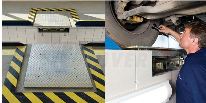
Obrázek č. 3 – Měření vůlí v řízení pomocí posuvných plošin, zdroj: http://www.univer.cz/obrazek.php?image=pris1_gst8500.jpg , („staženo dne 13. 4. 2016“)
