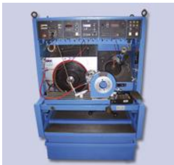
Obrázek č. 11 – Přístroj pro diagnostiku elektroagregátů ELKON U400 zdroj: http://www.dynas.cz/?page=elektrozkusebny , („staženo dne 13. 4. 2016“)
