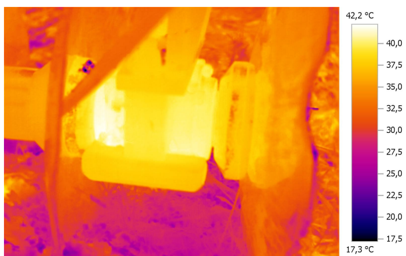
9. Termogram ložiska diskového podmítače
