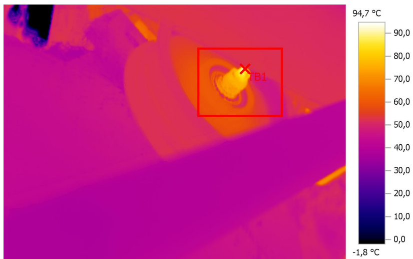
1. Termogram napínací kladky na sklízecí mlátiče
