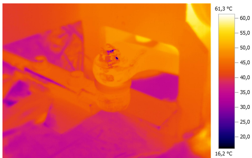
8. Termogram hlavice novější žací lišty
