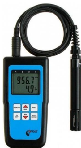
Obrázek 7 – Přístroj pro měření vlhkosti a teploty vzduchu , Zdroj: http://www.cometsystem.cz/ , „staženo dne 29.3.2016“
