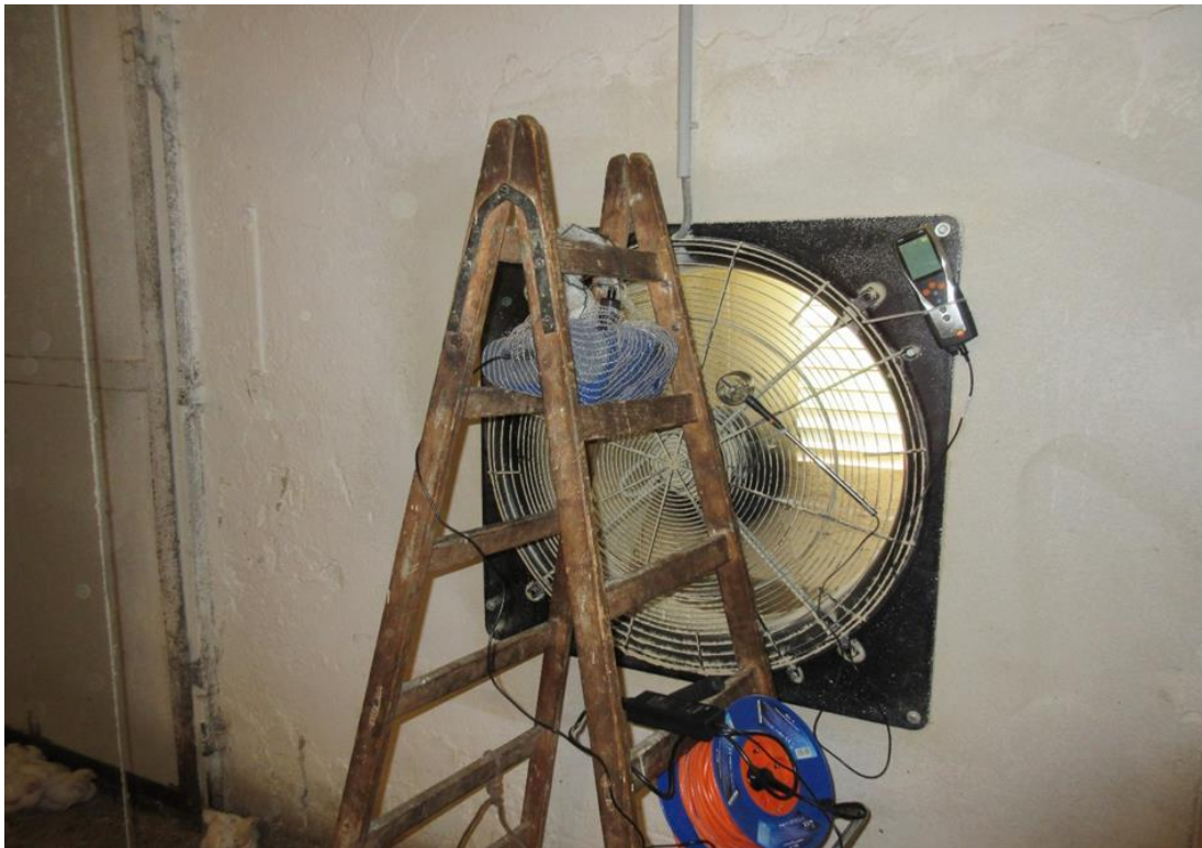
Obrázek 9 – Umístění přístroje ve stáji při výstupu vzduchu, Zdroj: autor
