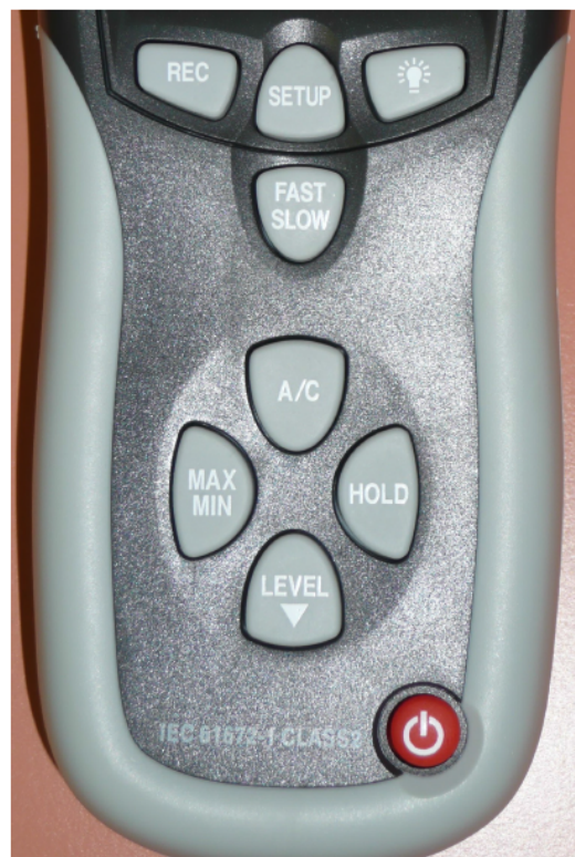
Obrázek 5 - Ovládací tlačítka hlukoměru
