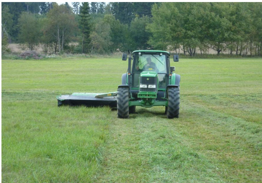
Obrázek 2: Sklizeň pomocí rotačního žacího stroje se spodním pohonem
