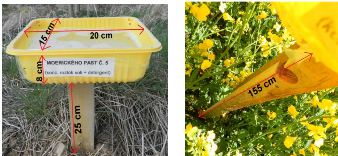
Obr. 19. Umístěné pasti – rozměry; nízký a vysoký podstavec.
