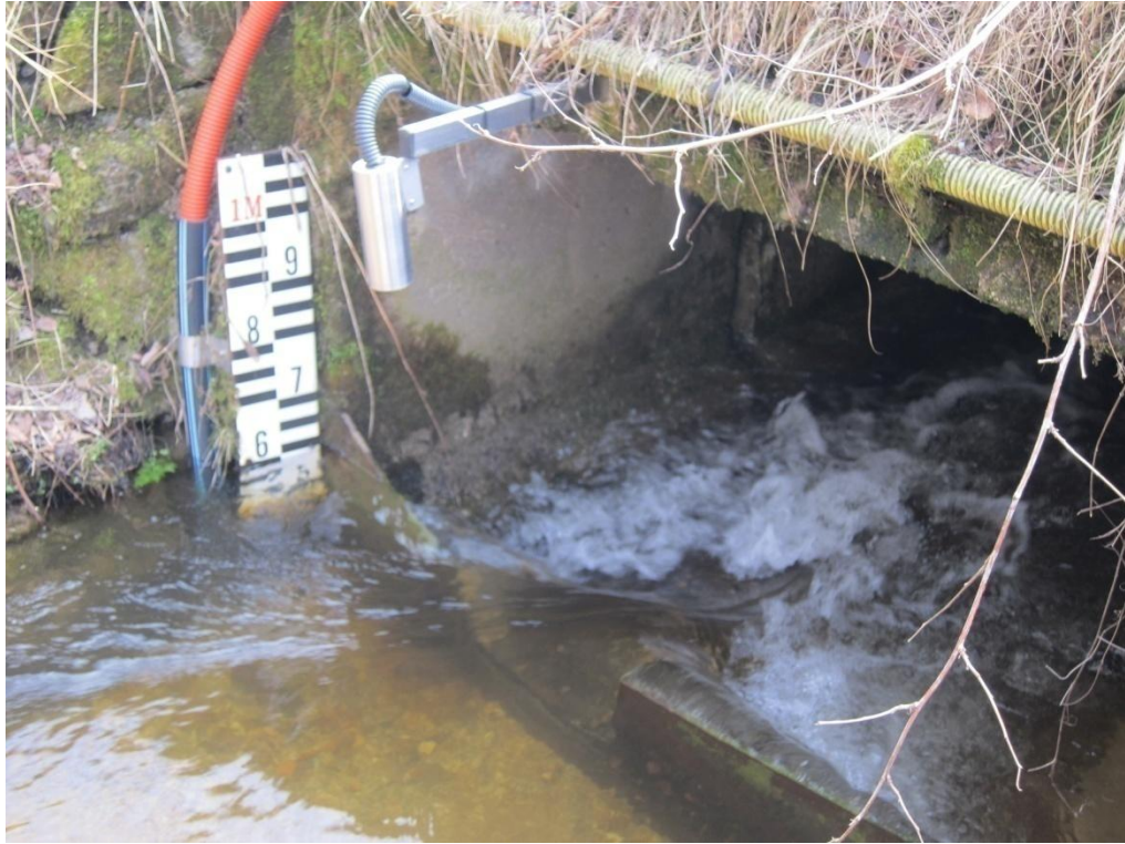
Obrázek 28. Instrumentace a měrný přeliv závěrného profilu povodí Horského potoka (foto:Procházka, 2012)
