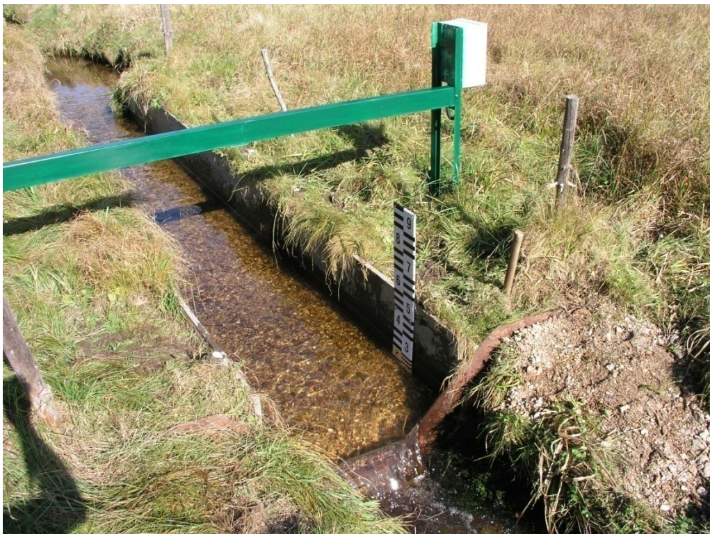
Obrázek 31. Závěrný profil povodí Bukového potoka s automatickým měřením výšky hladiny (ultrazvuk), vodivosti a teploty vody (foto: Procházka, 2010)
