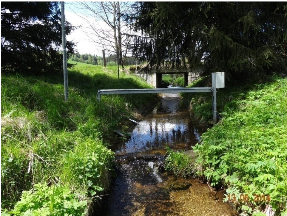
Obrázek 27. Závěrný profil s ultrazvukovým měřením výšky hladiny a s dataloggerem na Mlýnském potoce (foto: Vácha, 2015)
