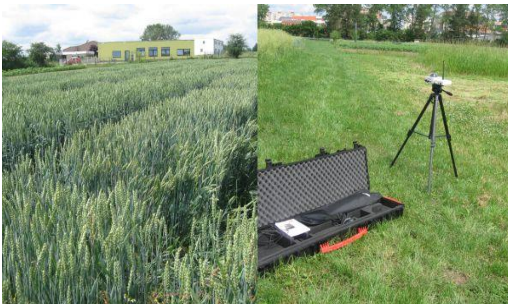
Foto 5: Měření porostu ozimé pšenice pomocí přístroje SunScan (BBCH 71 – 73)
