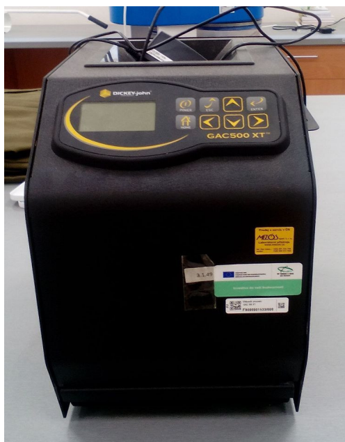
Obr. č. 1: Vlhkoměr GAC 500 XT
