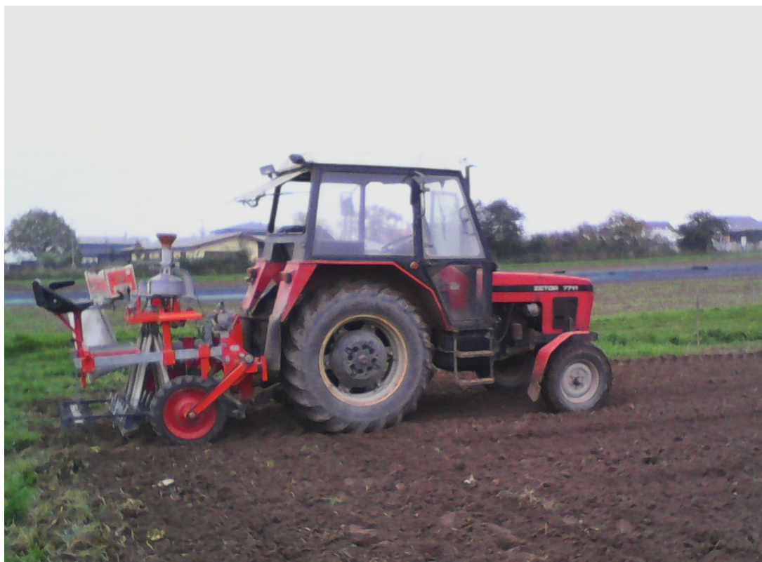
Obr. č. 7: Setí maloparcelkovým bezezbytkovým secím strojem HEGE
