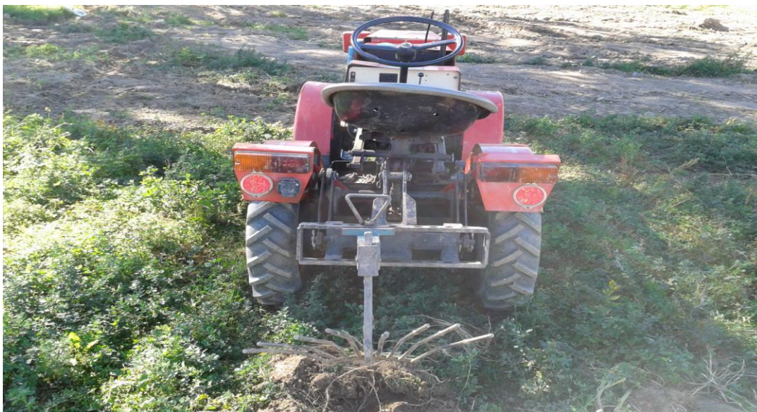
Obrázek č. 17: Malotraktor MTB - 132.2 s vyorávací radlicí
