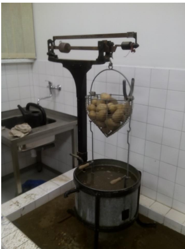
Obrázek 6: Měření obsahu škrobu na Hošpes – Petzold váze
