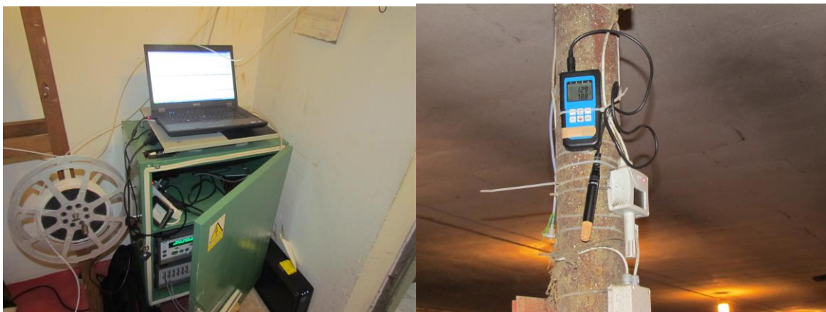
Obrázek 6. INNOVA 1412 a přístroje měřící mikroklima stáje při pokusu v teletníku Řepeč
