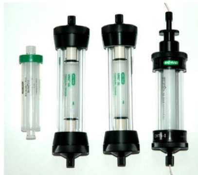
Obr. 6: Odsolovací „cartridge“ a kolony s keramickými náplněmi kompatibilní s FPLC systémem.
