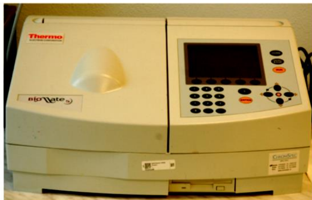
Obr. 13: Dvoupaprskový spektrofotometr BioMate 5 (Thermo, UK) vhodný pro měření enzymové aktivity.
