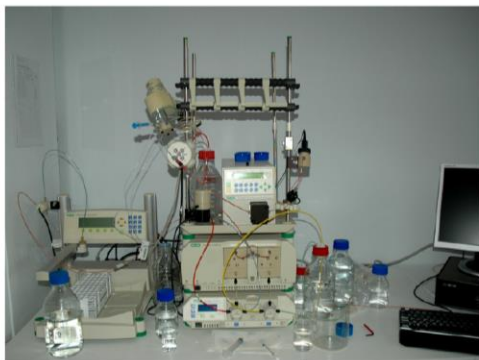
Obr. 5: Komplet středotlaké kapalinové chromatografie FPLC „BioLogic DuoFlow Pathfinder“ (Bio-Rad, USA) pro separaci a analýzu proteinů.
