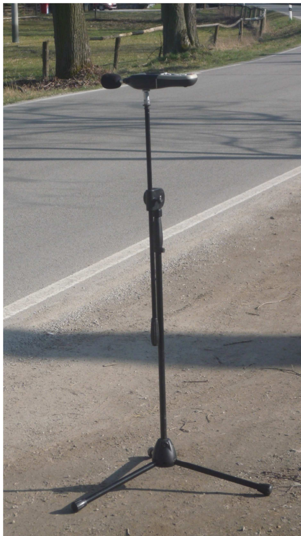
Obrázek 2 Použitý přístroj typu Voltcraft SL-400 na trojnohém stativu
