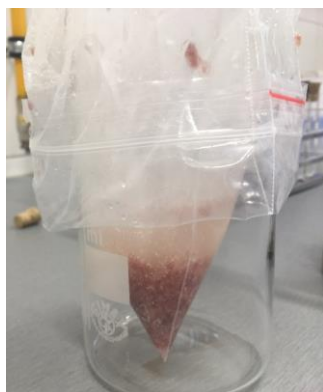
Obrázek 16: Ustálení vzorku po vyjmutí z homogenizátoru
