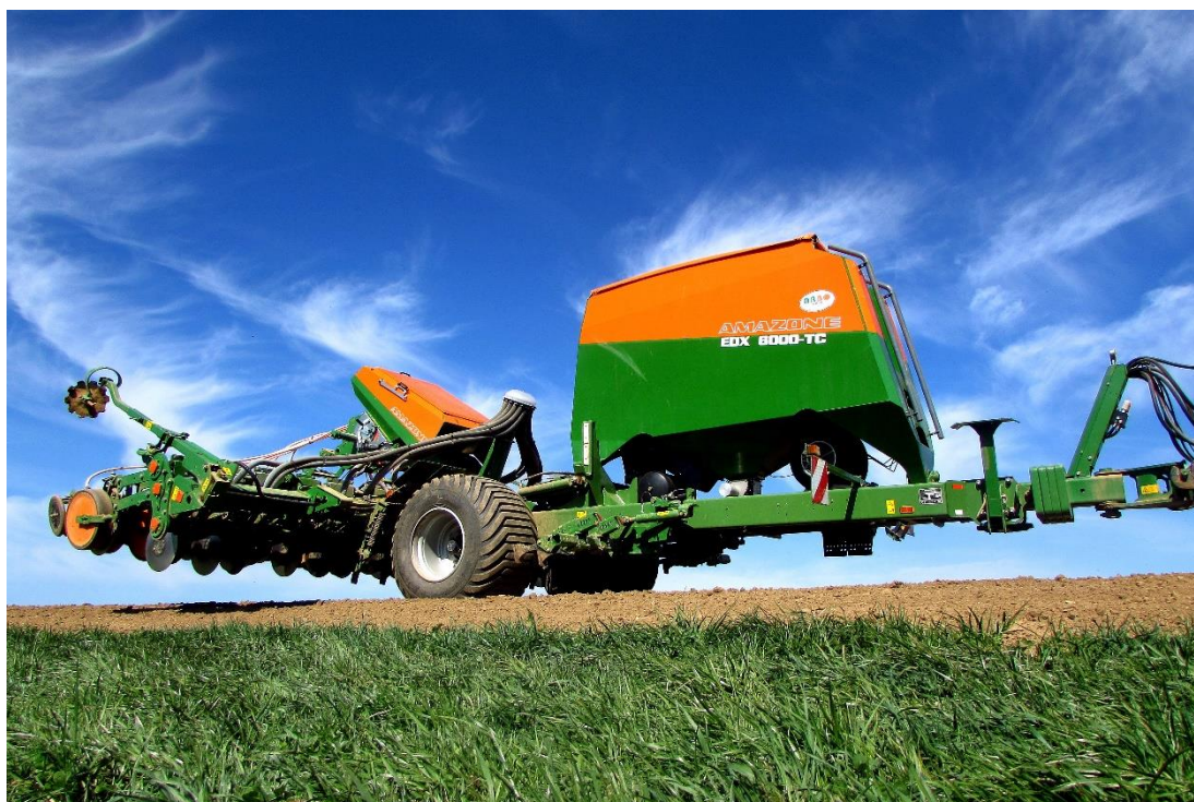
Obr. 22 Přesný secí stroj Amazone EDX 6000-TC
