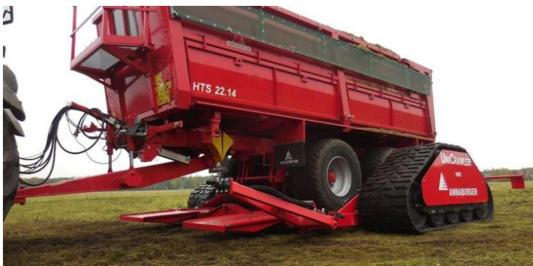
Obrázek č. 8: Speciální pásový podvozek Annaburger UniCrawler, zdroj: https://www.topagrar.pl/articles/top-technika/annaburger-sypnal-nowosciami/ „staženo dne: 7. 2. 2017“
