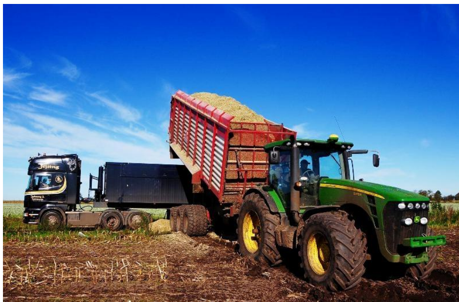
Obrázek č. 6: Překládací vůz pro siláž a senáž, zdroj: http://www.crs-marketing.cz/novinky/1603-prekladaci-vuz-na-senaze-annaburger-fieldliner-hts-29.06-pracuje-take-v-dansku „staženo dne: 7. 2. 2017“
