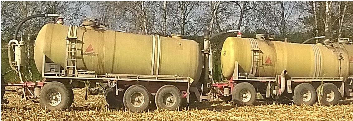
Obrázek č. 9: Rozdílné pneumatiky cisteren Annaburger HT 24.27
