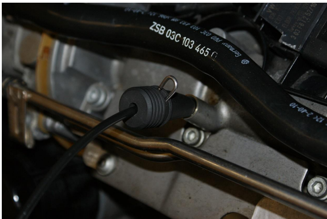
Obrázek č. 28 – Snímač teploty oleje zasunutý v otvoru po měrce oleje
