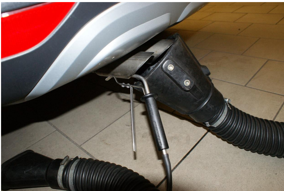
Obrázek č. 31 – Umístění měřicí sondy ve výfuku
