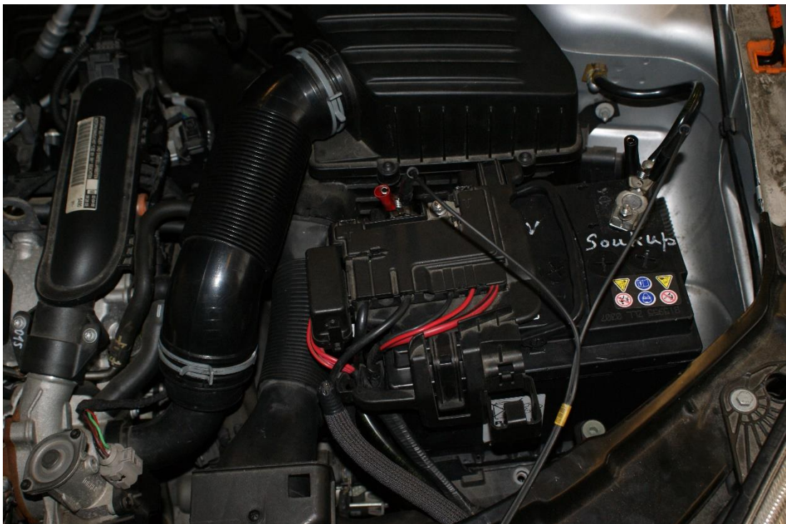
Obrázek č. 19 – Připojení svorek z motortesteru na akumulátor
