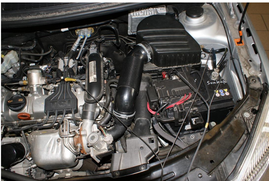
Obrázek č. 21 – Připojení napěťových kabelů ke krokosvorce a kostřicímu bodu, v tomto případě na akumulátor – regulační ventil
