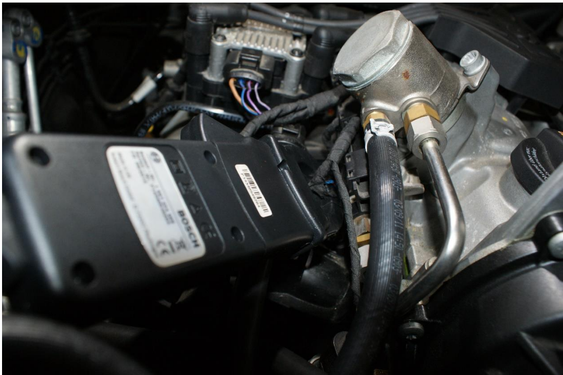
Obrázek č. 24 – Připojení klešťového ampérmetru na vedení vysokotlakého vstřikovacího ventilu
