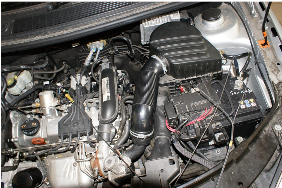
Obrázek č. 26 - Připojení napěťových kabelů ke krokosvorce a ke kostřičímu bodu, v tomto případě na akumulátor – regenerační ventil odpařeného paliva
