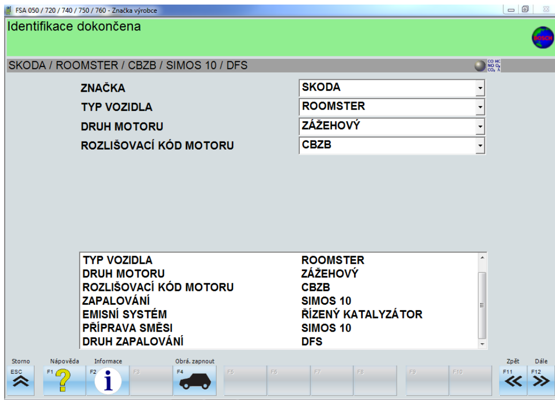
Obrázek č. 14 – Identifikace diagnostického vozidla motortesterem FSA 740
