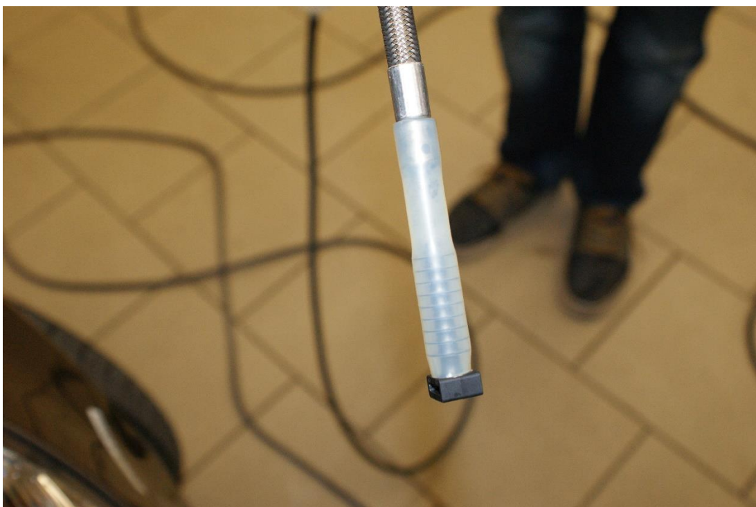
Obrázek č. 29 – Utěsněná měřicí sonda pomocí těsnicí trubice
