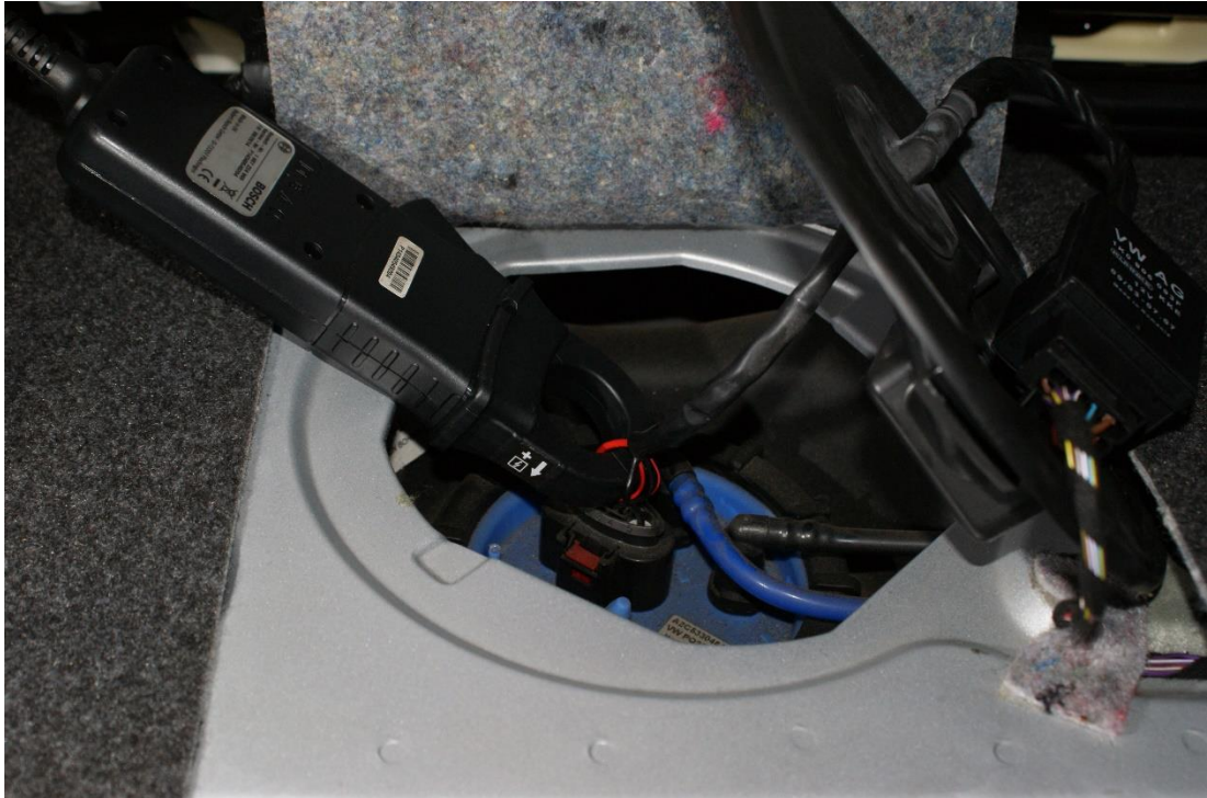
Obrázek č. 18 – Umístění klešťového ampérmetru při kontrole palivového čerpadla
