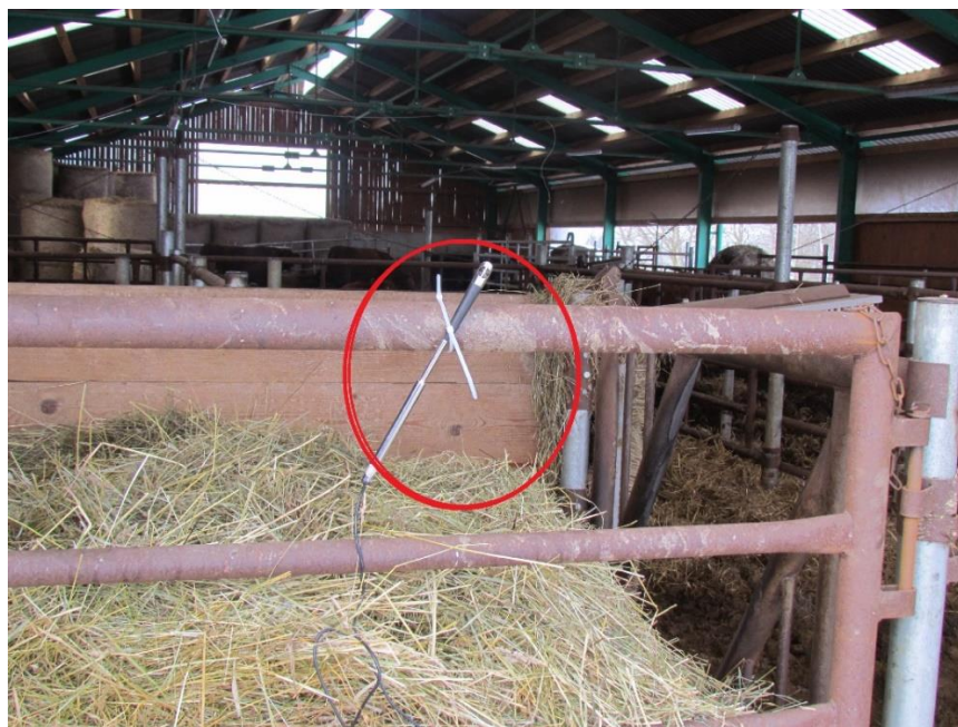
Obrázek č. 12 - Umístění anemometru na návětrné straně stáje
