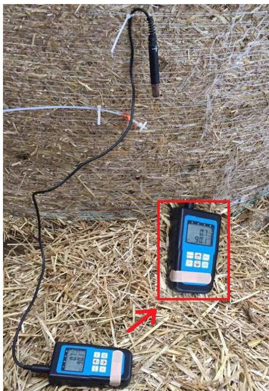
Obrázek č. 11 - Umístění venkovního teploměru Commeter D4141
