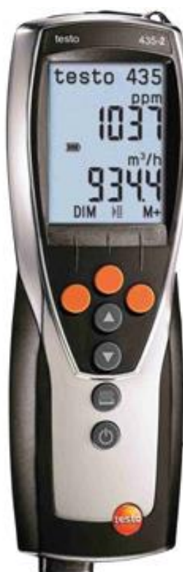
Obrázek č. 7 – Anemometr Testo 435,
