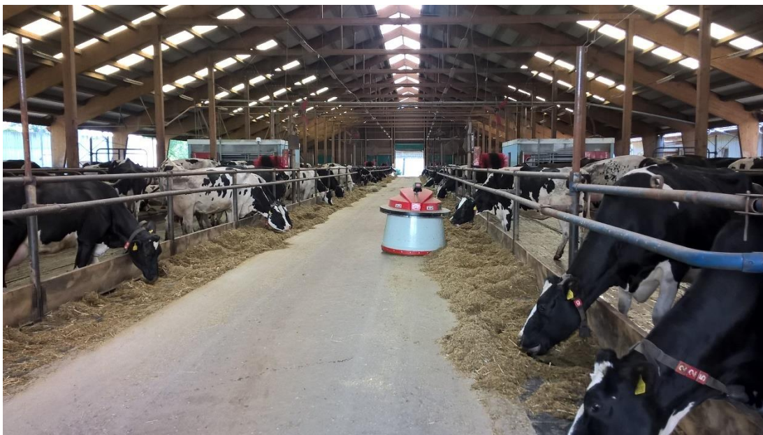
Obr. č. 3: Automatický přihrnovač krmiva slouží k přihrnování krmiva na krmném stole
