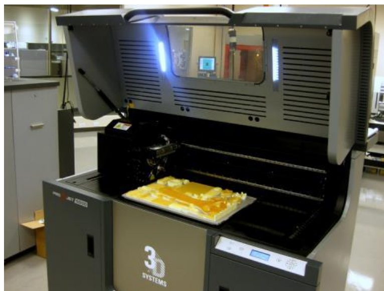
Obrázek 9 – Tiskárna MJM od 3D Systems, Inc. [14]
