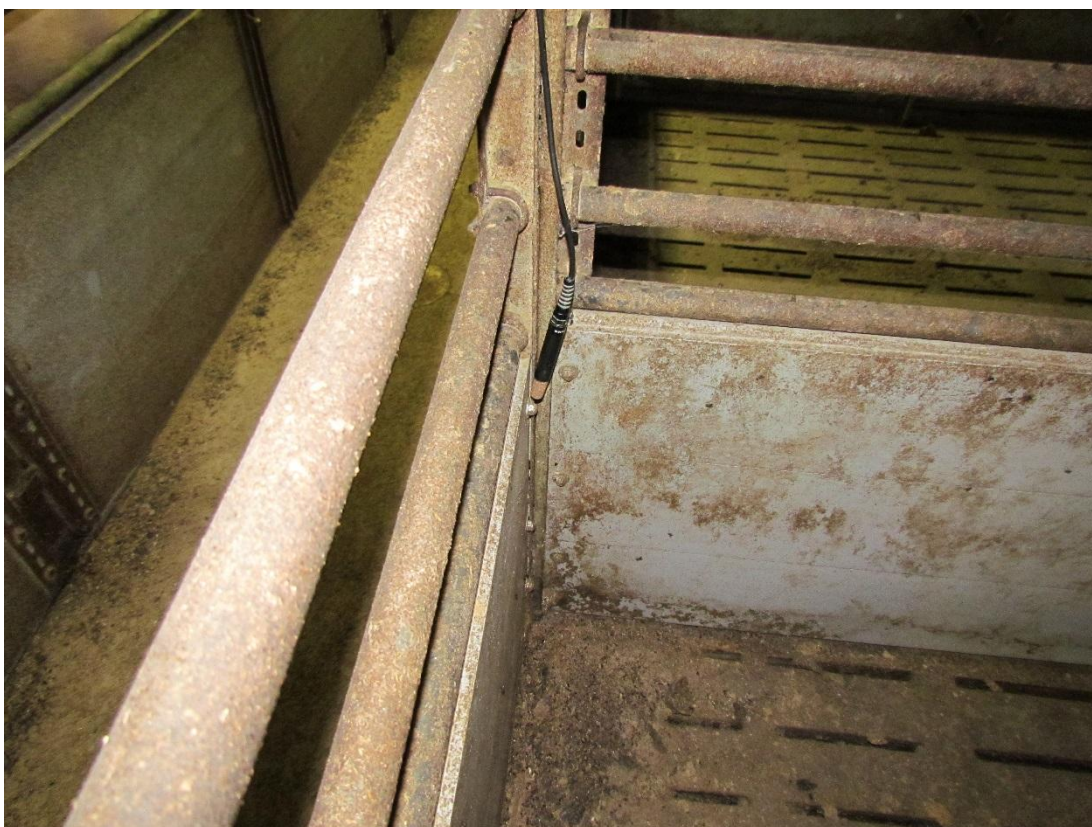
Obrázek č. 7: Foto umístění externí elektrody snímající teplotu a vlhkost koje
