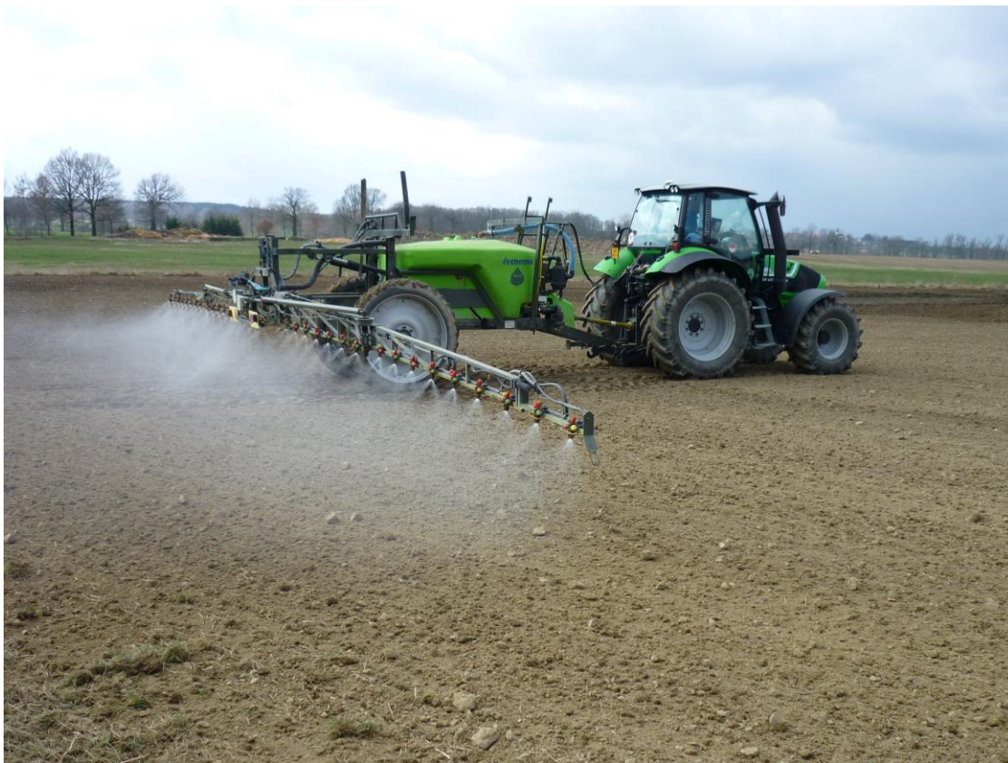
Obr. č. 9: Preemergentní aplikace herbicidů za pomoci traktoru Deutz-Fahr Agrottron TTV 420 s postřikovačem Tecnomax Galaxy (foto: Tupá, 24.3. 20016)
