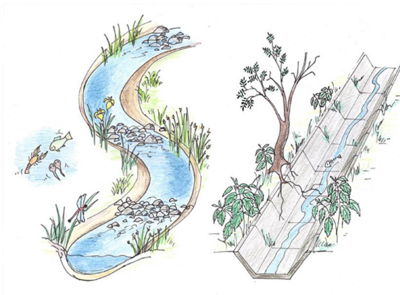
Obrázek č.7 – Revitalizované a regulované koryto, zdroj: JUST a KOL., (2005)
