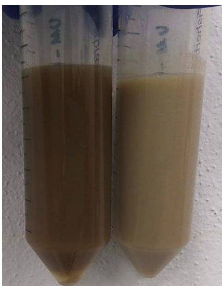
Obr. 24: vlevo nevysrážený extrakt, vpravo po isoelektrickém srážení
