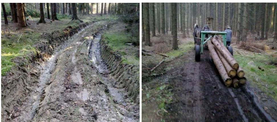
Obr. č. 42 a 43: Srovnání efektu použití kolového traktoru a kolesny. Fotografie pořízeny ve stejném prostoru vyklízení a při vyklízení přibližně stejného množství dřeva. Lokalita Orlické hory (zdroj: Svoboda, Gallas a kol., 2012).
