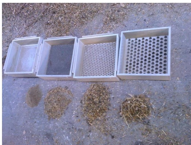
Obr. č. 2: Separace pevných částic na Penn state separatoru
