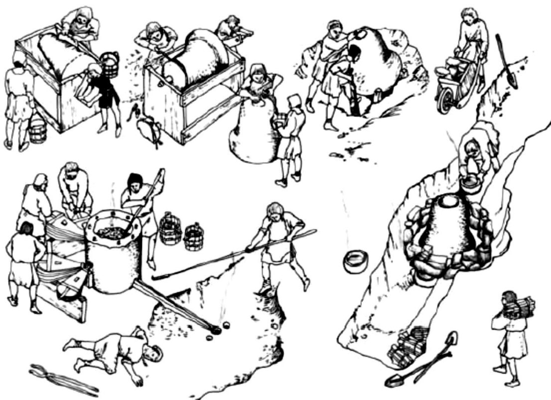
Obr. 13 – Kresebná rekonstrukce jednotlivých postupů při odlévání zvonů (převzato z Juřina – Kašák – Samojská 2007, 127).
