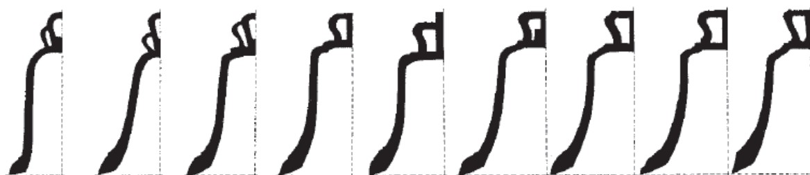
Obr. 23 – Vývoj profilu zvonového žebra (Převzato z Manoušek 2006, 28 ).
