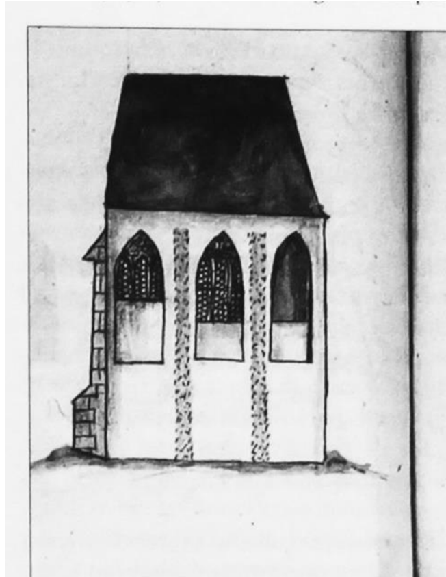
[10] Svatá Dobrotivá, pohled presbytář klášterního kostela od severu. Původní opěráky naznačeny šrafováním. Stav v roce 1676.
