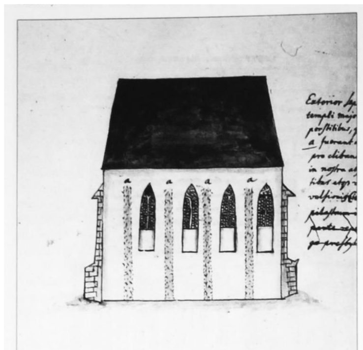
[12] Svatá Dobrotivá, pohled na severní stěnu trojlodí kostela. Původní opěráky naznačeny šrafováním. Stav v roce 1676.
