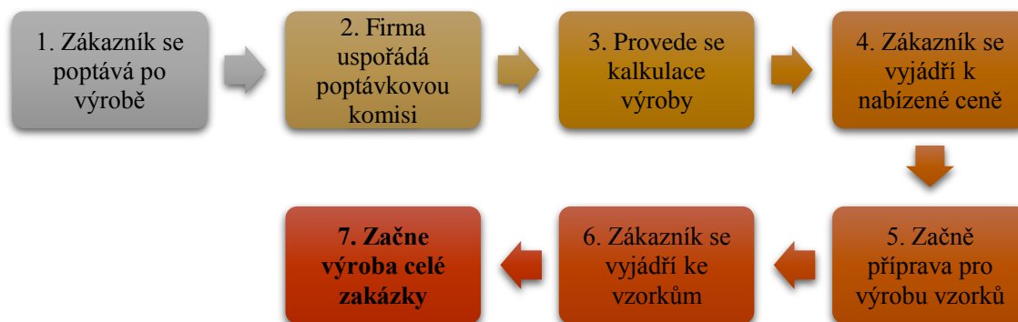
Obrázek 43: Proces zavedení výroby nového výrobku
