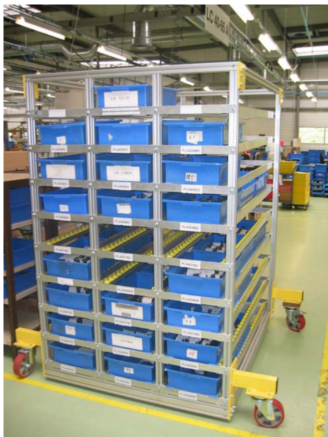
Obr. 20 : Gravitační regál pro cívky
