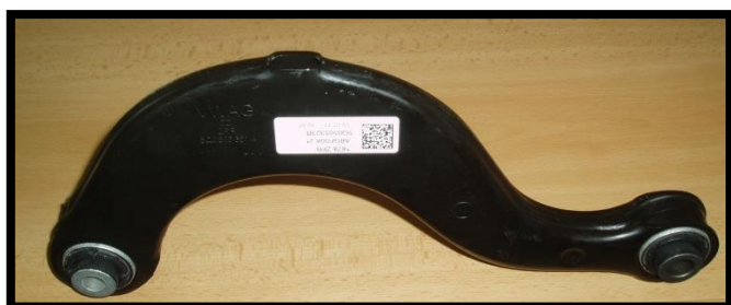
Obrázek 6 – Kontrolní rameno zadní nápravy
