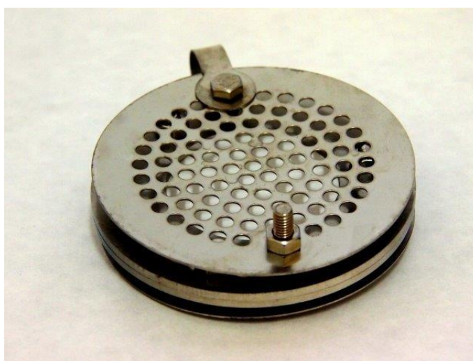
Obr. 2: Ochranný obal vzorkovače POCIS (E&H Service, Praha)
