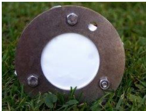
Obr. 1: Pasivní vzorkovač POCIS (E&H Service, Praha)
