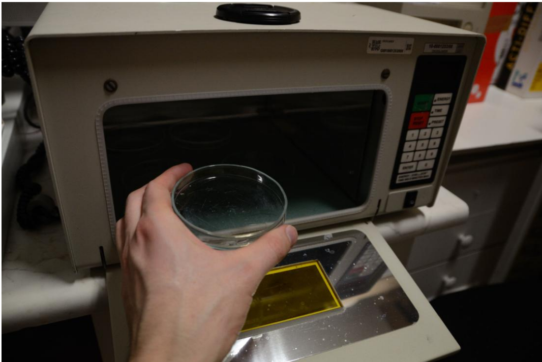
Příloha č. 1: UV crosslinker CL-1000, použitý k inaktivaci paternálního genomu spermatu. Foto I. Lebeda
