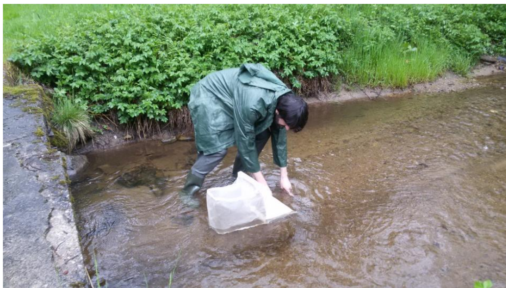
Obr. 2: Odběr vzorku z písčitého substrátu dna.
