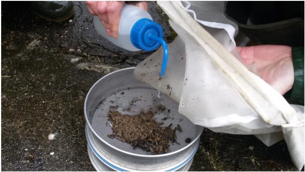
Obr. 5: Přemístění odebraného vzorku ze vzorkovače do kovového síta.
