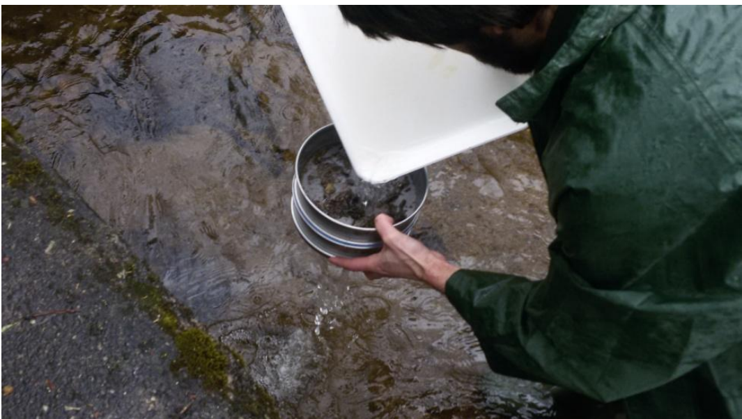
Obr. 6: Promývání vzorku vodou, abychom docílili odstranění jemného sedimentu.
