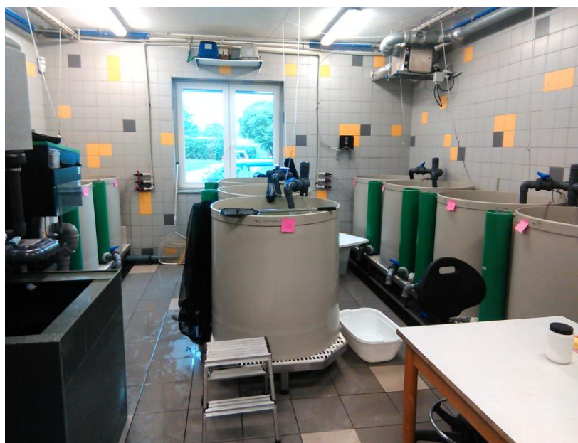
Obr. 3 Recirkulační systém použitý pro intenzivní chov pokusných jedinců mníka jednovousého ( Lota lota ).
