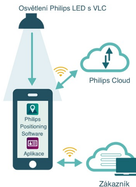
Obrázek 23: Princip fungování Philips Indoor Positioning
