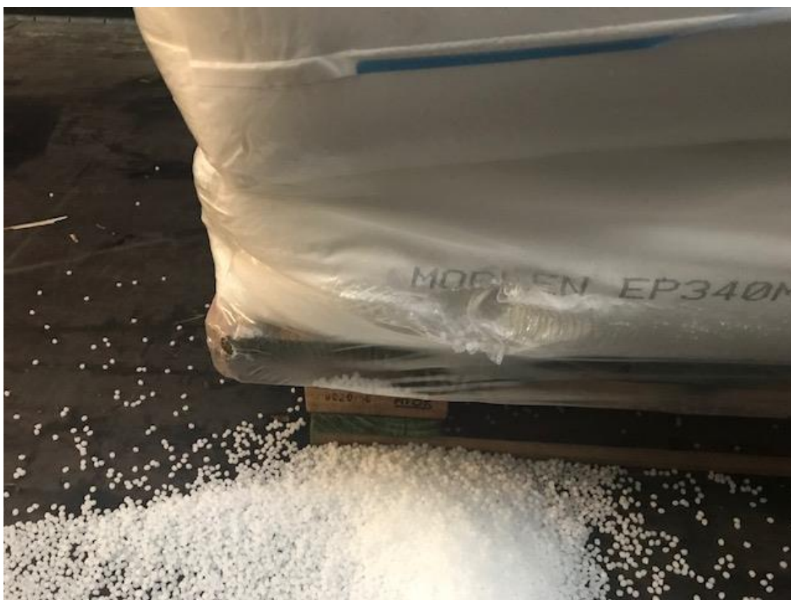
Obrázek 19: Příklad poškození obalu špatnou manipulací pracovníkem
