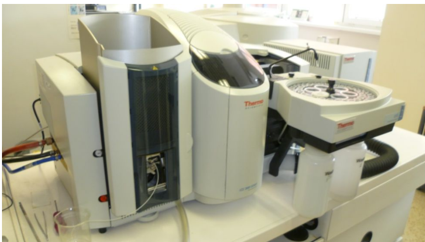
Obr. 3: AAS Thermo Scientific iCE 3500 (foto: Jiří Krejsa).
