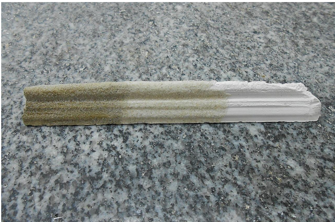
Obr. 10: Imitace páskovce na zkušebním modelu
