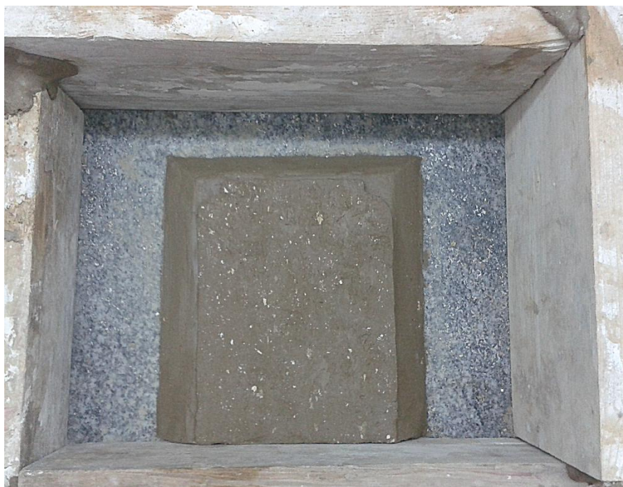
Obr. 6: Příprava formy na výrobu dveří
