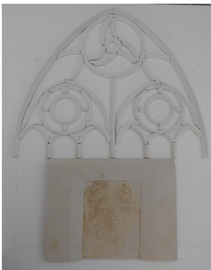
Obr. 8: Broušení, skládání a lepení profilů k sobě
