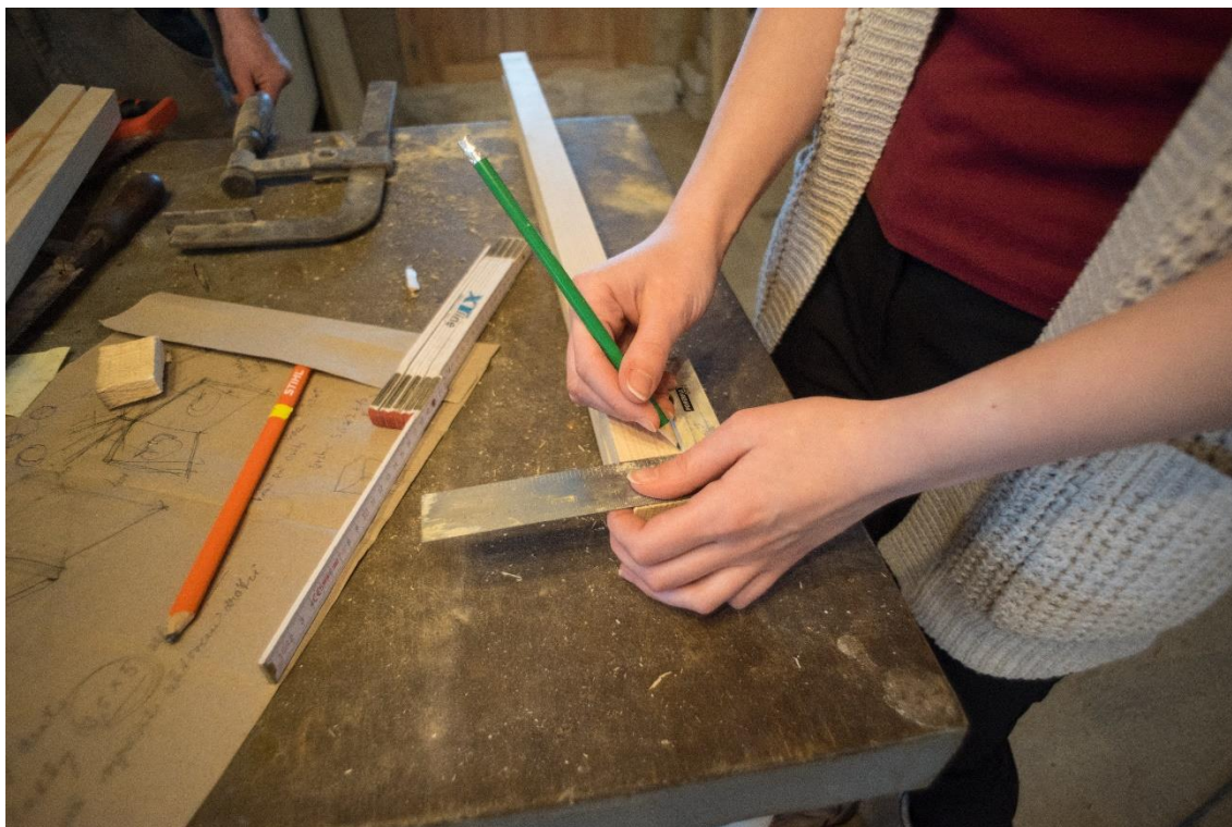
Obr. 3: Rozměření lišt pro vydlabání spojů
