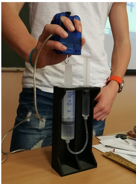
Obrázek 86: Testování držáku injekčních stříkaček žáky.
