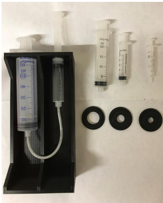
Obrázek 24: Vytisknutý 3D model držáku.
