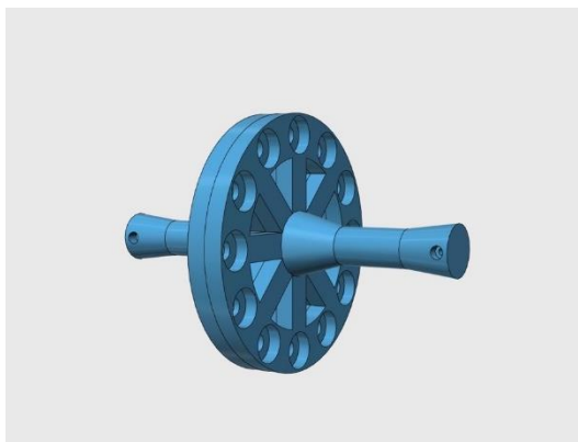
Obrázek 31: Spojené Maxwellovo kolo.
