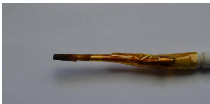
Obr. č 7 – Langmuirova sonda, wolframový drátek vystupující z izolace
